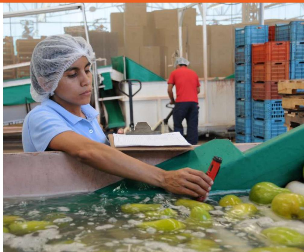
Os tanques de água na casa de embalagem são usados para remover o látex, pó, sujeira e folhas que as mangas trazem. O tanque hidrotérmico serve para eliminar a presença da mosca da fruta e o resfriador a água para resfriar rapidamente as mangas e estas poderem ser acondicionadas.
